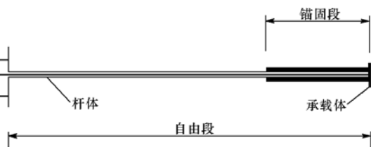
图7 压力集中型预应力锚杆结构原理图
