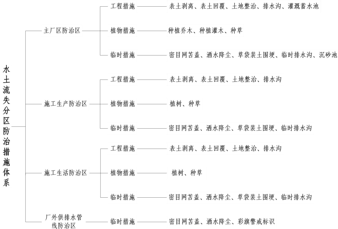
图 3.4-2 实际实施的水土保持措施总体布局
